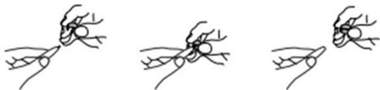
② 将上盖逆时针旋转 75° 后拔出
